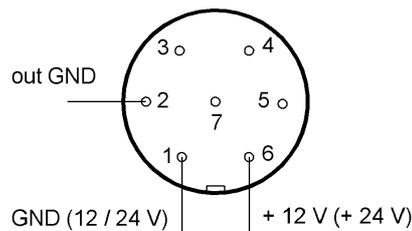
**Socket on cable „Power Supply“:**
